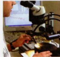
Abb. links: Hölzer werden auf einem Tisch unter Lupenvergrößerung gemessen. Rechts: Der Computer registriert die Strecke, die der Tisch von Jahrringgrenze zu Jahrringgrenze bewegt wird, und erstellt die Jahrringkurve. © Links: E. Guggenbichler. Rechts: LAD Baden-Württemberg
